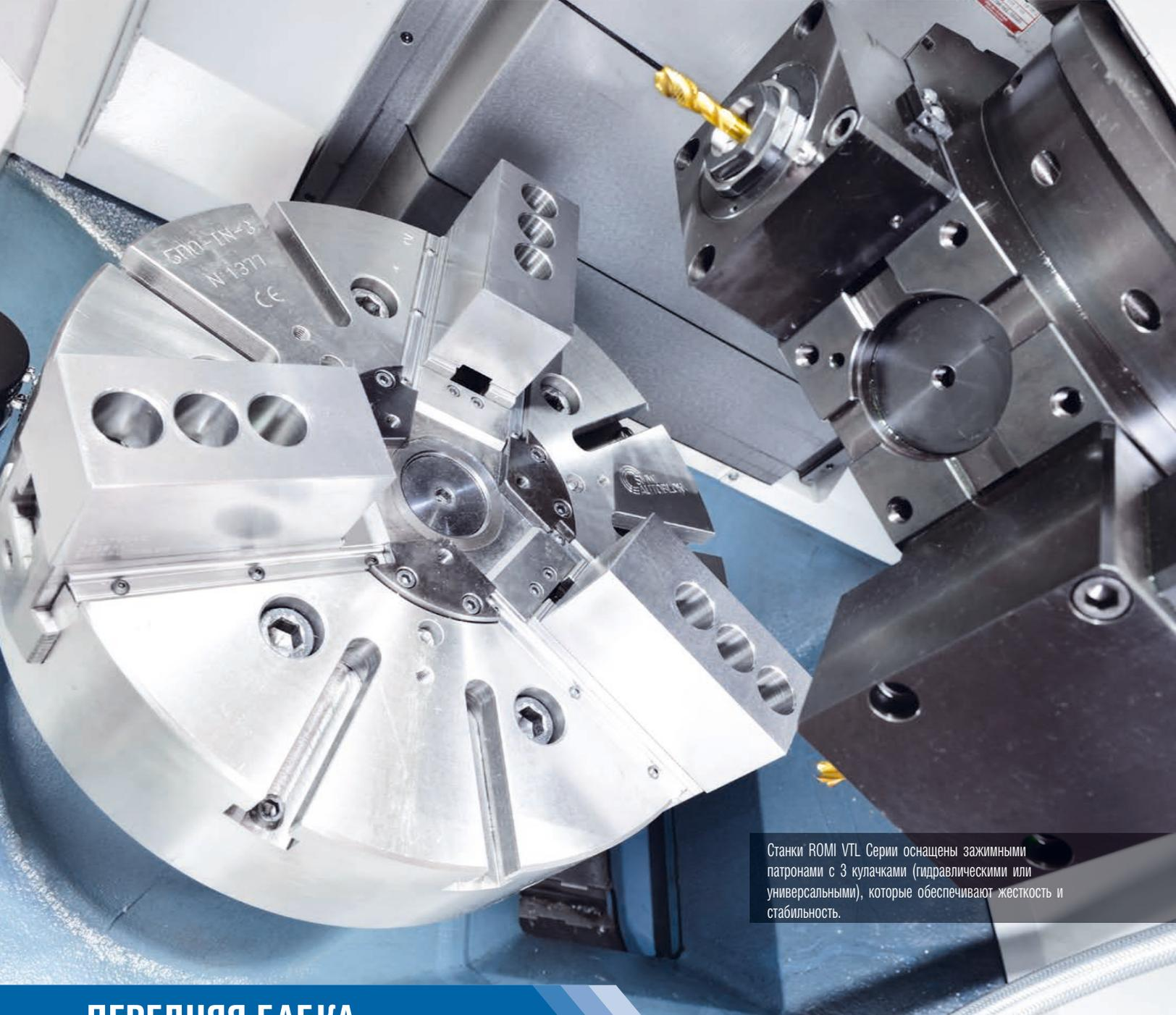
Станки ROMI VTL Серии оснащены зажимными патронами с 3 кулачками (гидравлическими или универсальными), которые обеспечивают жесткость и стабильность.
