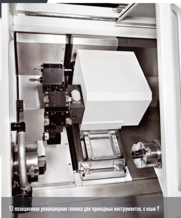
12-позиционная револьверная головка для приводных инструментов, с осью Y
