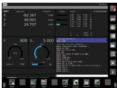
1. Оболочка пользователя, обеспечивает отображение различной информации на одном экране. Например: подачи осей и индикатор нагрузки главного шпинделя, текущая программа, M-коды, информация о инструменте, иконки, ошибки и т.п.
