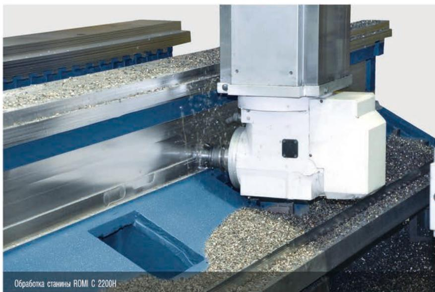
Чугунный прочный корпус с внутренними ребрами, способен выдерживать большие нагрузки тяжелой обработки.
