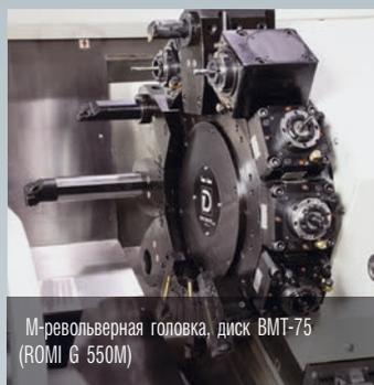
M-револьверная головка, диск BMT-75 (ROMI G 550M)
