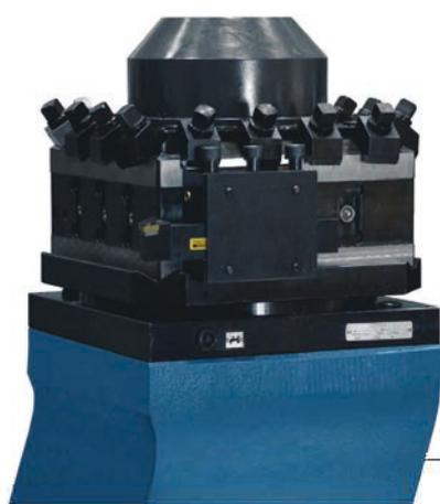
4 - позиционная вертикальная револьверная головка с электроприводом
