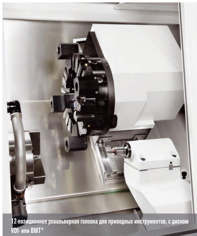
12-позиционная револьверная головка для приводных инструментов, с диском VDI- или BMT\*
