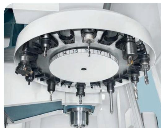
Устройство Автоматической Смены Инструментов с магазином на 20 инструментов (ROMI D 600)
