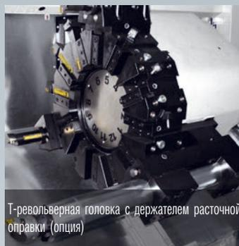
T-револьверная головка с держателем расточной оправки (опция)
