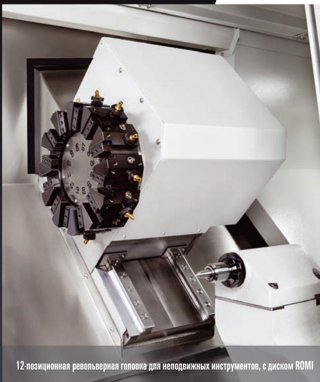
12-позиционная револьверная головка для неподвижных инструментов, с диском ROMI
