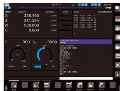
1. Различная информация отображается на одном экране. Например: поддачи осей и индикатор нагрузки главного шпинделя, текущая программа, M-коды, информация о инструменте, иконки, ошибки и т.п.
