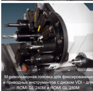
М-револьверная головка для фиксированных и приводных инструментов с диском VDI - для ROMI GL 240M и ROMI GL 280M
