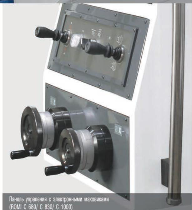
Панель управления с электронными маховиками (ROMI C 680/ C 830/ C 1000)
