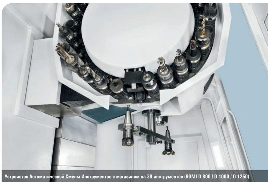
Устройство Автоматической Смены Инструментов с магазином на 30 инструментов (ROMI D 800 / D 1000 / D 1250)
