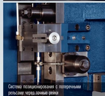
Система позиционирования с поперечными рельсами через точные рейки
