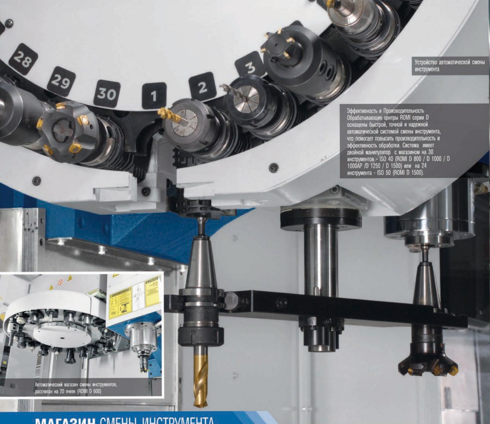
Устройство автоматической смены инструмента
