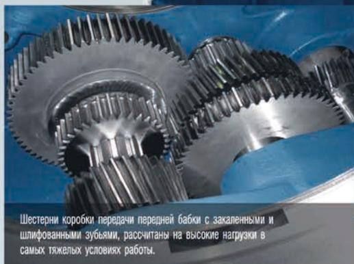
Шестерни коробки передачи передней бабки с закаленными и шлифованными зубьями, рассчитаны на высокие нагрузки в самых тяжелых условиях работы.
