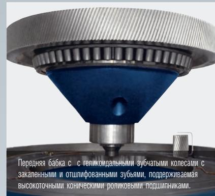
Передняя бабка с геликоидальными зубчатыми колесами с закаленными и отшлифованными зубьями, поддерживаемая высокоточными коническими роликовыми подшипниками.
