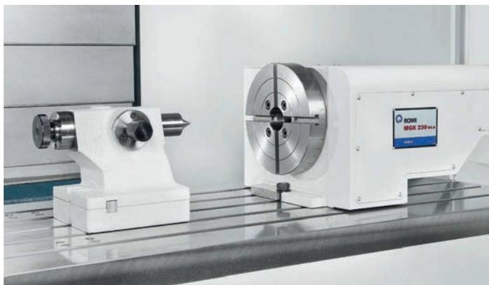
Эта опция позволяет производить обработку деталей под любым углом и с непрерывной интерполяцией. Это обеспечивает превосходное позиционирование и повторяемость. Его мощная конструкция и жесткость обеспечивает отличное вибропоглощение. Для обработки длинных деталей может поставляться с дополнительной задней бабкой.
