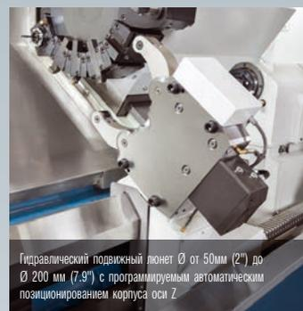
Гидравлический подвижный люнет Ø от 50мм (2") до Ø 200 мм (7.9") с программируемым автоматическим позиционированием корпуса оси Z
